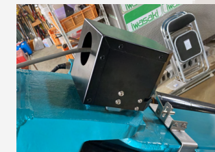
センサー取付ボックス
