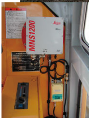
GPS機器設置状況
