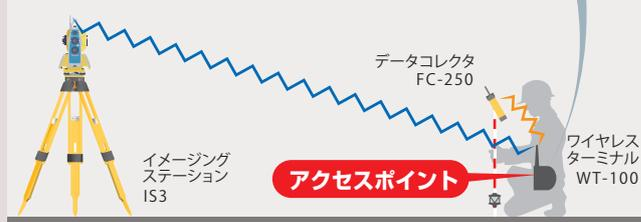
\*通信距離は通信機器間の障害物や状況により変化します。IS3とWT-100アンテナとの間に視通が取れ、周囲の状況が良い場合に最大300mまでの通信が可能です。IS3とWT-100アンテナの見通しが取れるように使用してください。
